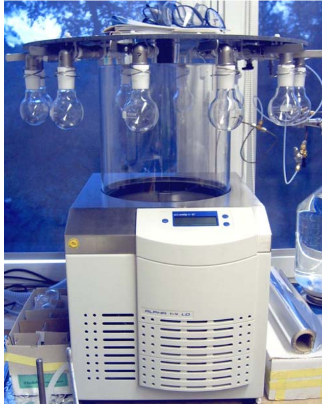
Abbildung 3-2: Gefriertrocknungsanlage mit den modifizierten Kugelhähnen
